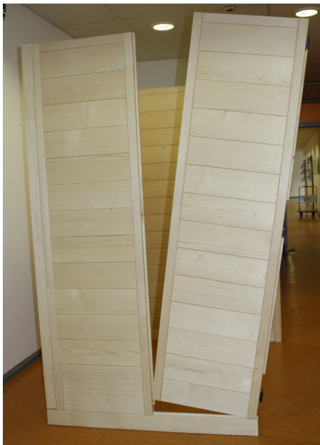
Fig. 9: Montagem dos dois suportes de canto frontais com ranhura para vidro
