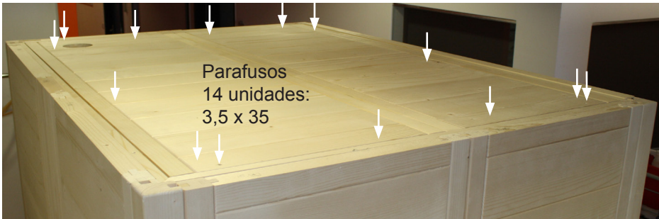
Fig. 19: Fixação dos elementos de teto
