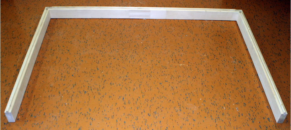
Afb. 1: Plaatsen van de drie bodemframe-elementen
