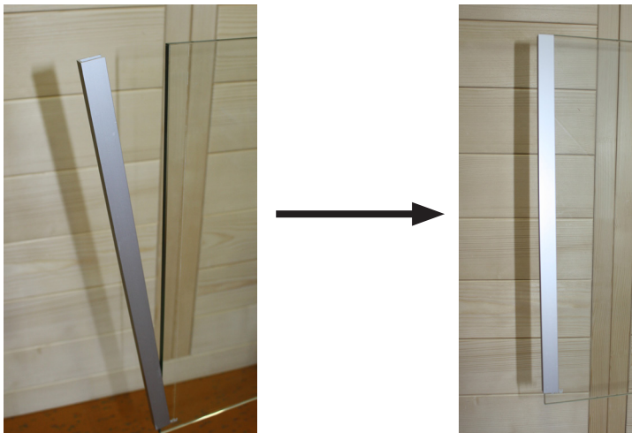
Fig. 11 : Montage des profilés en U sur les plaques en verre
