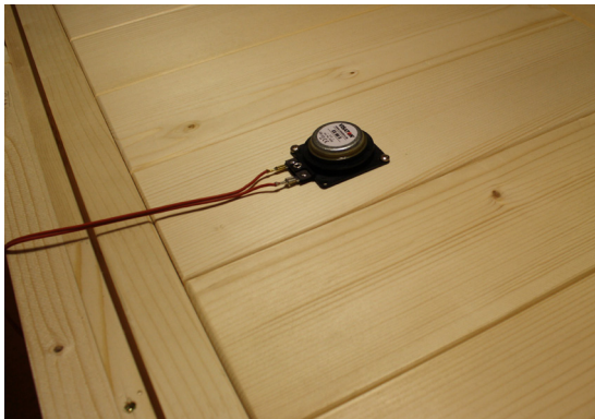
Fig. 47 : Montage des excitateurs
